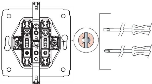
Pour éviter tout risque d'endommagement par un vissage trop fort des vis, il convient de prendre en compte la force de vissage maximale selon la norme IEC 60884-1. Lors de l'utilisation de tournevis électriques, il est recommandé un réglage préalable de la force de vissage à 0,5/0,6Nm.
