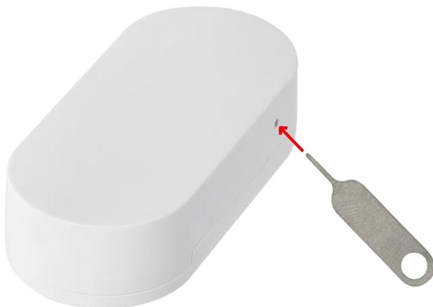
Reinicia el dispositivo con el pin suministrado manteniendo pulsado el botón de reinicio hasta que la luz indicadora empiece a parpadear. A continuación, empareja el sensor con tu teléfono.
